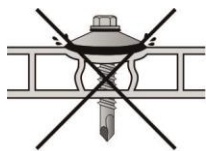
Рисунок 13а. Неправильно — избыток перенапряжения
